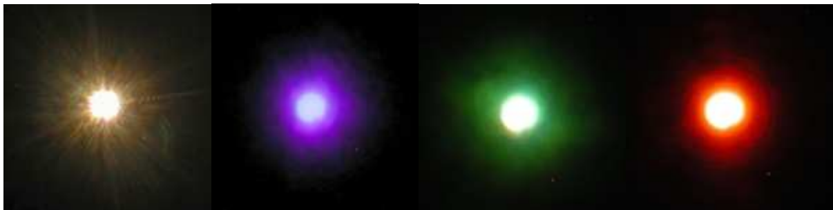
Sterntest mit 20µ Pinhole im Fokus mit einem 2,5mm Okular und mit den Farbfildern Für die F-Linie blau. = 486.1 nm - Für die F-Linie grün. = 546.1 nm Für die F-Linie rot. = 656.3
